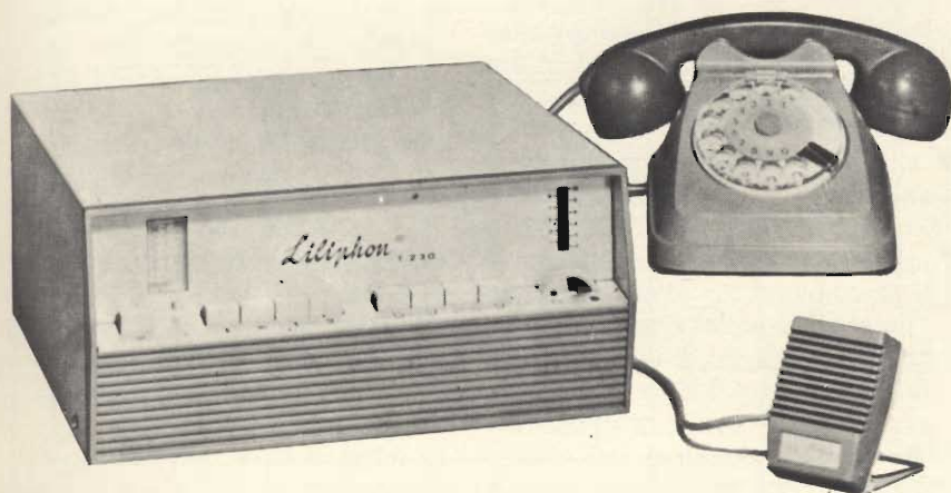
Fig. 5 - Vista d'insieme di un impianto di segreteria telefonica LILIPHON T230-S.
