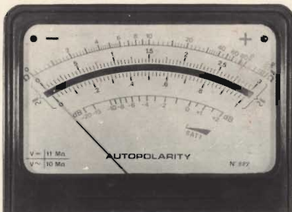
Fig. 2 - Vista ravvicinata delle scale di lavoro dell'R127. L'altissimo grado di controreazione dei circuiti, ha reso possibile la coincidenza della scala dei V c.c. con quella dei Vc.a. anche per valori iniziali.
