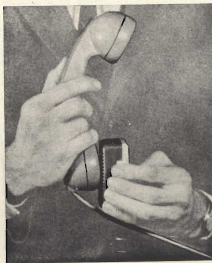
Fig. 8 - La fotografia illustra il sistema di impiegare il trasmettitore per comandare l'ascolto a distanza dei messaggi registrati dal segretario telefonico Liliphon T230-S.
