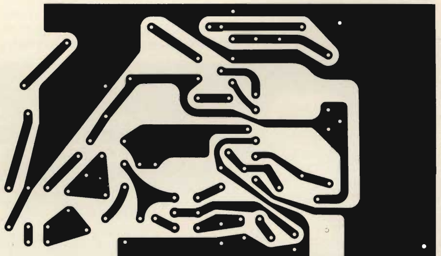
Fig. 7 - Circuito stampato del trasmettitore visto dal lato rame e in scala 1 : 1.
