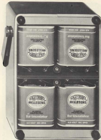
Fig. 4 - Vista posteriore dello strumento con la sistemazione delle 4 batterie da 4,5 V. Il consumo complessivo si aggira sui 20 mA solamente.
