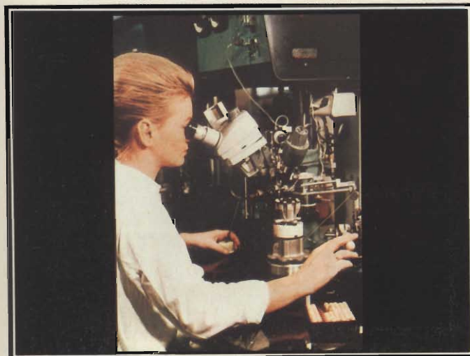
Fig. 51 - Circuito integrato a semiconduttori - Realizzazione dei collegamenti.
