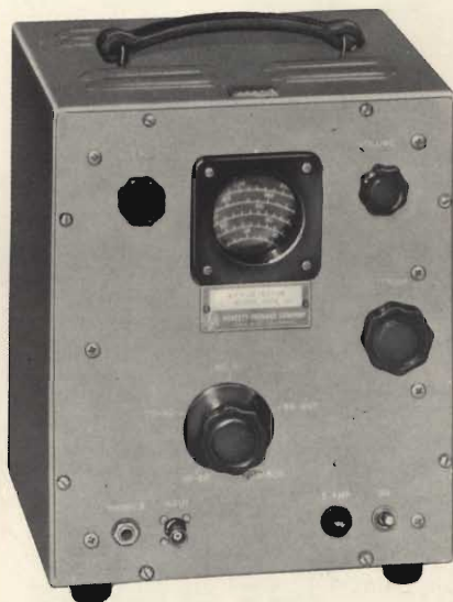
Fig. 1 - Foto frontale di un Rivelatore H-P in banda da 10 a 500 MHz impiegato come rivelatore per ponti a Radio Frequenza.
